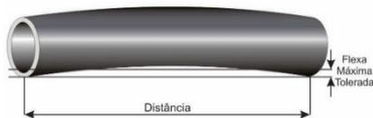
Flecha máxima tolerada: 0,6mm\* por metro linear de comprimento da haste tubular (distância entre os dois apoios). Caso seja medido com relógio comparador, considerar duas vezes (2x) o valor do empenho máximo informado acima.
