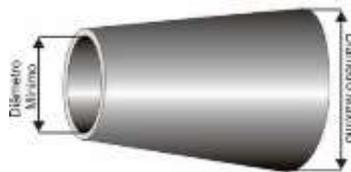
**BRUNIDO** - Máximo de conicidade permitida: a diferença entre a maior e a menor medida do diâmetro interno em uma mesma secção transversal do tubo, não pode ser maior do que a diferença entre a máxima e a mínima medida de diâmetro na ISO H9.
