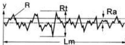
Típico de material trefilado, permitindo marcas de armazenamento. Defeitos superficiais com profundidade máxima de 0,3mm
