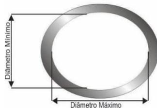
**SEM BRUNIMENTO** - Máximo de ovalização permitida: a diferença entre a maior e a menor medida do diâmetro interno em uma mesma secção transversal do tubo, deverá estar contida na qualidade dimensional IT9 e dentro da tolerância dimensional.
