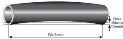
Flecha máxima tolerada: 0,6mm por metro linear de comprimento do tubo (distância entre os dois apoios). Caso seja medido com relógio comparador a flecha equivale à metade da leitura total do instrumento.
