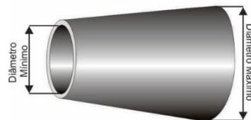
**SEM BRUNIMENTO** - Máximo de conicidade permitida: a diferença entre a maior e a menor medida do diâmetro interno ao longo da peça, deve estar contida na qualidade dimensional IT9 e dentro da mesma tolerância dimensional.
