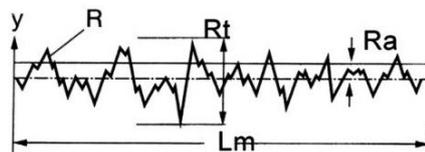
Típico de material trefilado, permitindo marcas de armazenamento. Defeitos superficiais com profundidade máxima de 0,3mm
