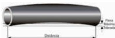
Flecha máxima tolerada: 0,6mm\* por metro linear de comprimento da haste tubular (distância entre os dois apoios). Caso seja medido com relógio comparador, considerar duas vezes (2x) o valor do empenho máximo informado acima.
